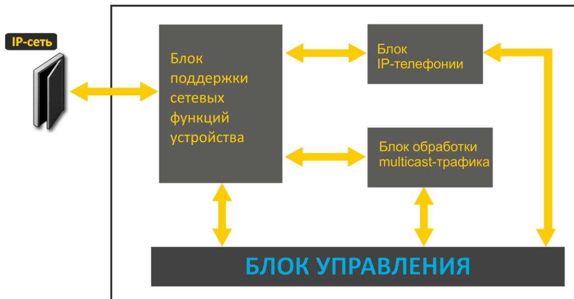
Рисунок 3 — Функциональная схема устройства серии *TAU-2M.IP*
