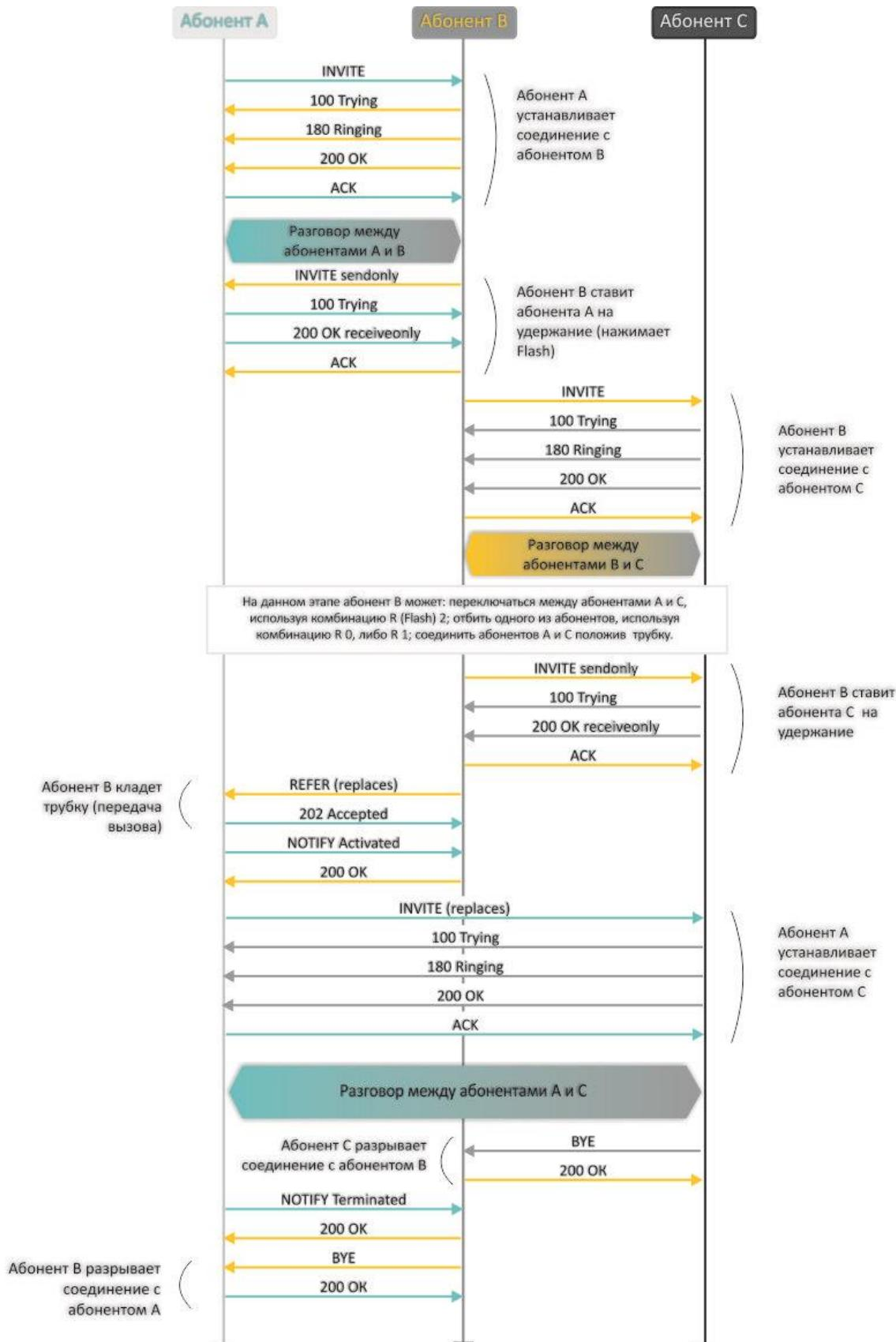
Услуга «*Unattended calltransfer*» позволяет поставить на удержание абонента, находящегося на связи (абонент А), с помощью короткого отбоя flash и осуществить набор номера другого абонента (абонента С). Передача вызова осуществляется автоматически по окончанию набора номера абонентом В.
