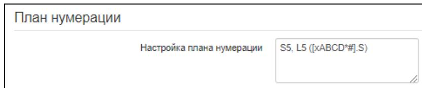
План нумерации задается при помощи регулярных выражений в поле «Настройка плана нумерации».
