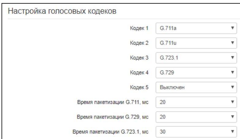
Сигнальный процессор устройства выполняет функции кодирования аналогового речевого трафика, данных факса/модема в цифровые сигналы, а также обратного декодирования. Шлюз поддерживает следующие голосовые кодеки: G.711A, G.711U, G.729, G723.1, G.726, G.722.
